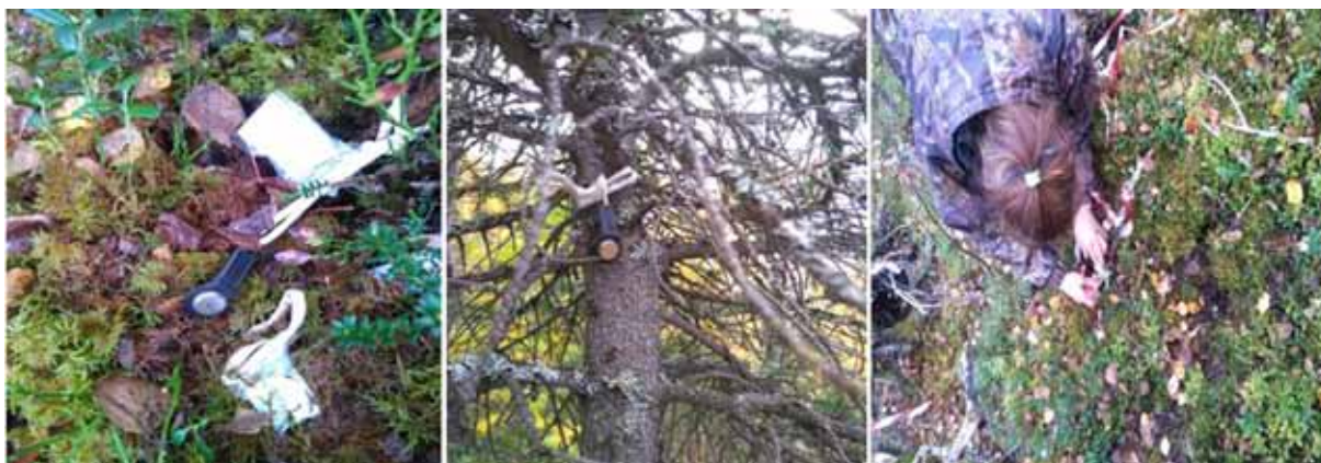
Рис. 3. Закладка термохрон на глубину 5 см, воздух и на поверхность подстилки.
