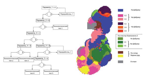
Рис. 1. Прогнозирование минералого-технологических свойств руды in situ Ковдорского бадделеит-апатит-магнетитового месторождения: условная блок-схема переработки руды (слева) и геометаллуригческая модель (справа) (по (Иванюк и др., 2017; Калашников, Иванюк, 2019 б)).
