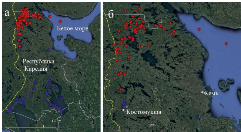
▲ - действующий карьер, на котором производят массовый взрыв ● - землетрясения на территории Карелии, которые произошли за период 2000 - 2019 гг.
