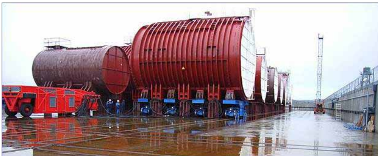
Рис. 1. Пункт долговременного хранения реакторных отсеков АПЛ в Сайда-Губе.
